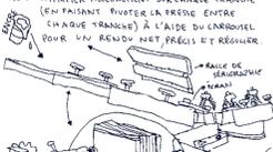
10: IMPRIMER AUVÈSMENT SUR CHAQUE TRANCHE (EN FAISANT PIVETER LA PRESSE ENTRE L'AXE DE ROTATION) À L'AIDE DU CARROUSEL POUR 'AU BESOIN' METTRE PRÈS ET RÉGLER
