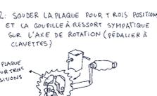
SOUDER LA PLAQUE POUR TROIS POSITION ET LA GOUILLE À RESSORT SYMPATHIQUE SUR L'AXE DE ROTATION (PÉDALIER À CLAVETTES)
